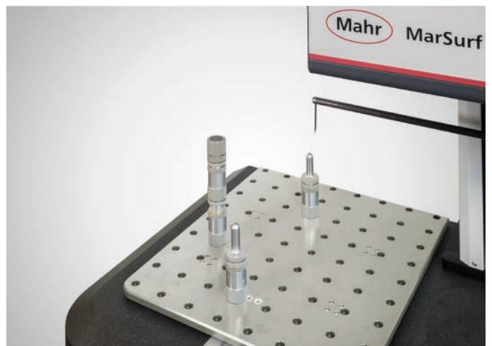
Placa de fijación con conjunto de puntos de fijación ajustables, incluidos la punta de centrado y el fijador magnético
