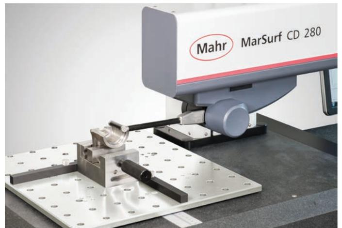
Medición con el palpador transversal CPG A 33-210-25/30 q50
