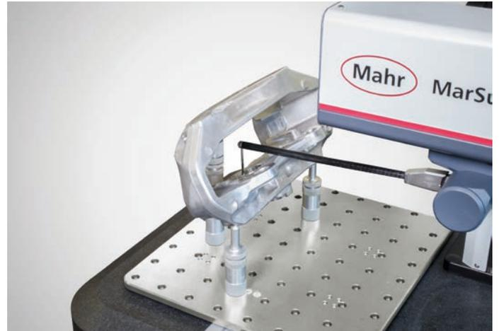
La medición con punta de palpado larga CPG A 62-350-25/19° permite acceder a puntos de medición profundos
