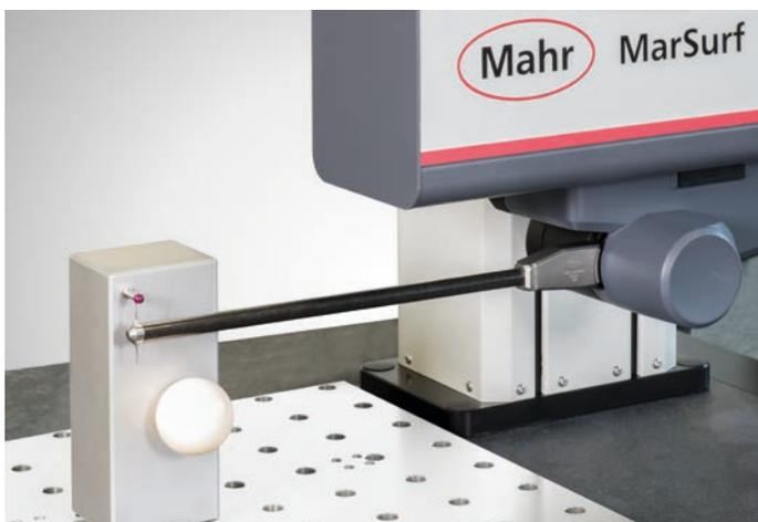
Medición con la punta de doble palpado en el patrón de calibración
