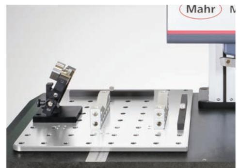
Dispositivo de sujeción flexible y bloques prismáticos
